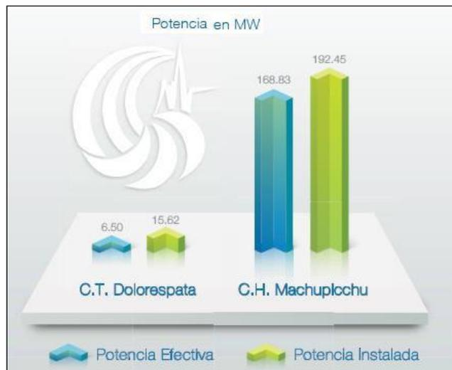
En cuanto a la potencia efectiva de la Central Hidroeléctrica Machupicchu es de 168.83 MW, con un caudal promedio de 55.86 m<sup>3</sup>/seg; mientras que la potencia efectiva de la Central Térmica Dolorespata es de 6.50 MW, según nuevo estudio.
